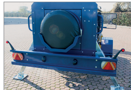
▲ End-outline markers and spare wheel Feux d'encombrement et roue de secours
