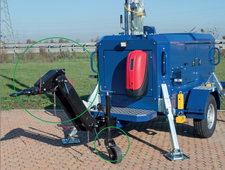
▲ Road trailer with adjustable towbar and jockey wheel Remorque routière avec crioche réglable et roulette pivotante
